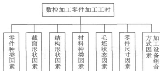
图1 数控加工零件工时估算影响因素体系
